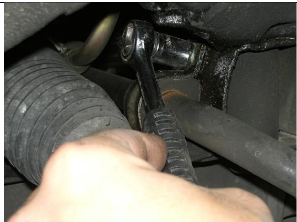
Mit 13er Nuss Stabi-Halterung lösen
