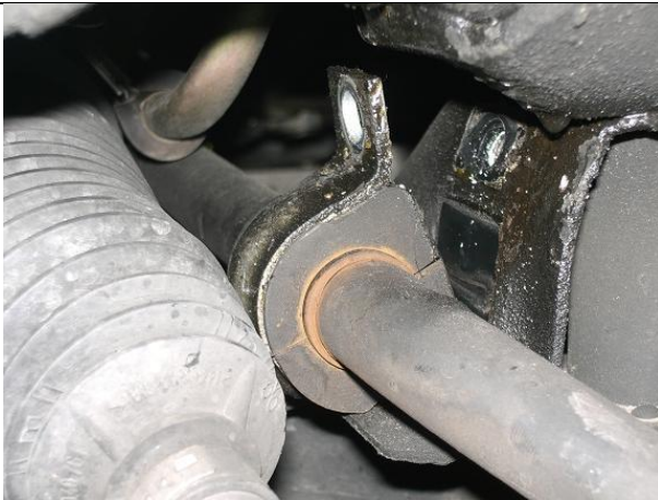
Halterung mit Stabi-Lager in Fahrtrichtung abnehmen
