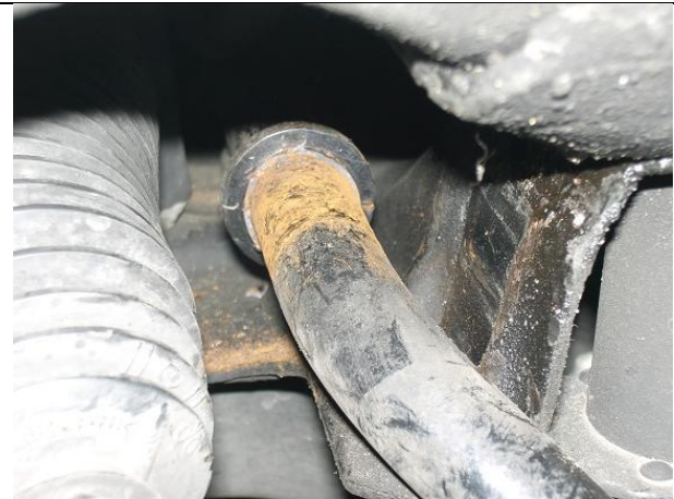
Gebrochene Stabi-Hülse komplett entfernen
