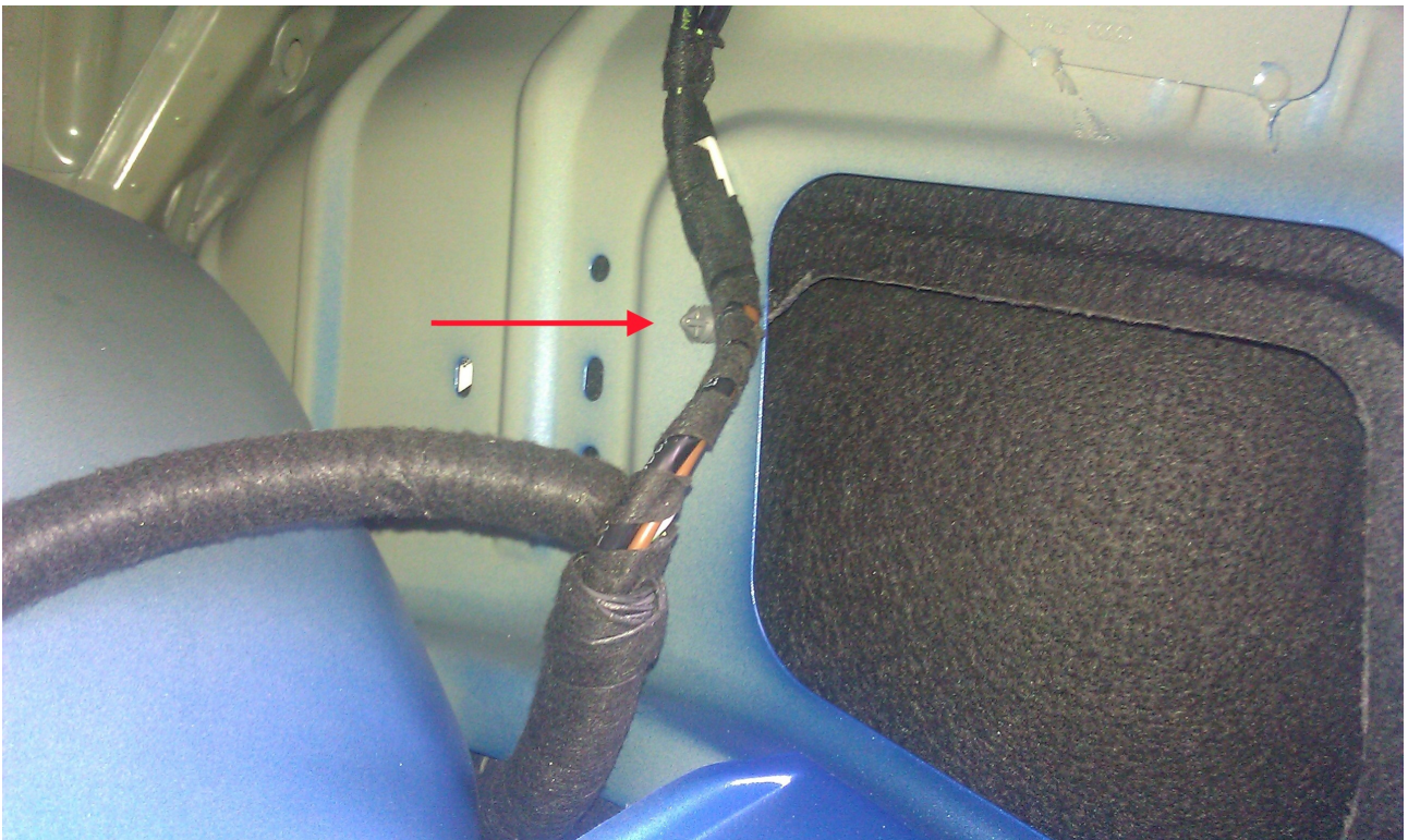
[Bild 07: Hier kann man einen Tannenzapfenclip bei der Serviceklappe von innen ganz gut sehen]
