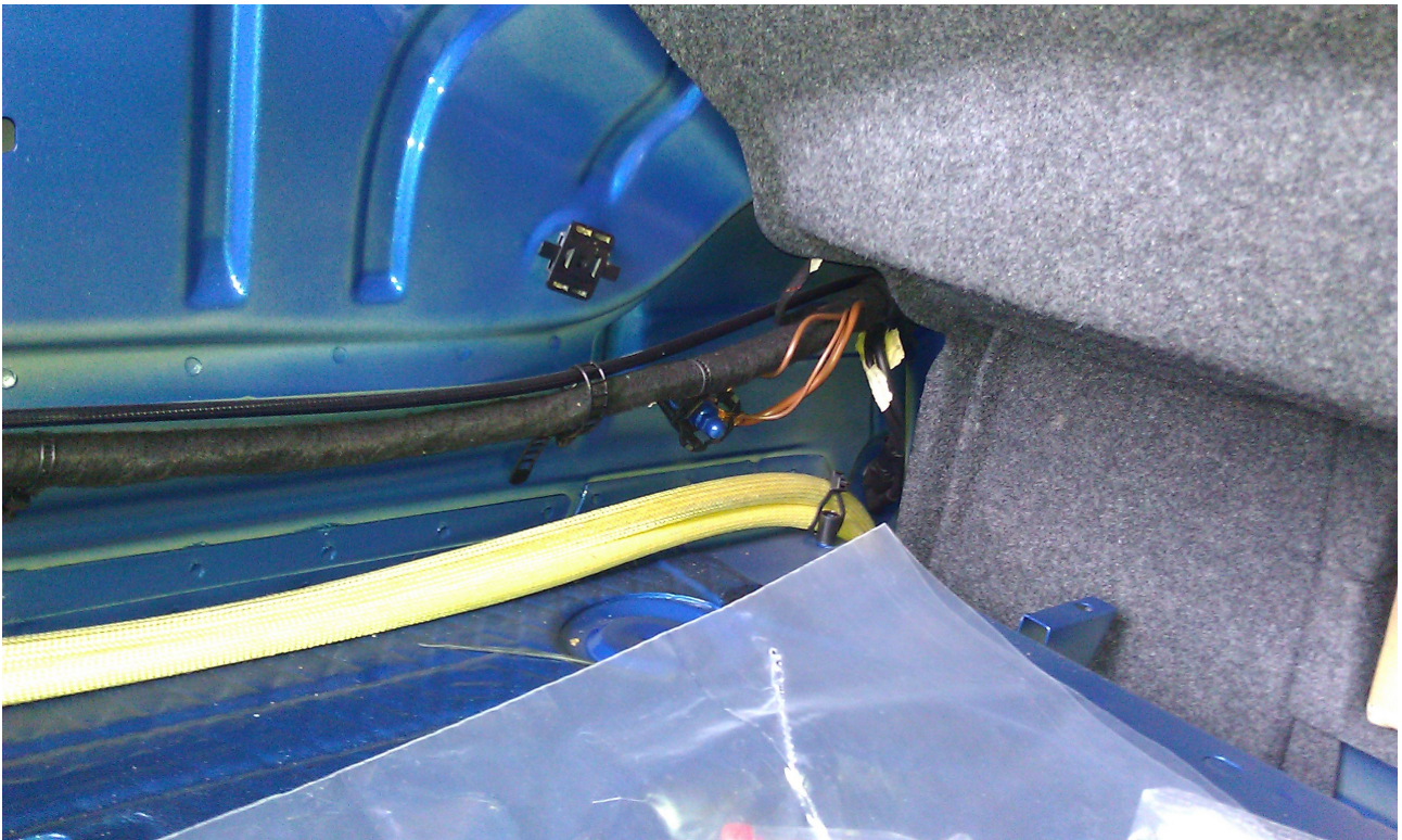
[Bild 08: Hier ein Blick auf besagten vorderen Befestigungspunkt, das schwarze Dings ungefähr in Bildmitte oberhalb des Kabelstrangs. Die gelben Schläuche unten sind übrigens die Plus-Leitungen von der Batterie in Richtung Motorraum.]
