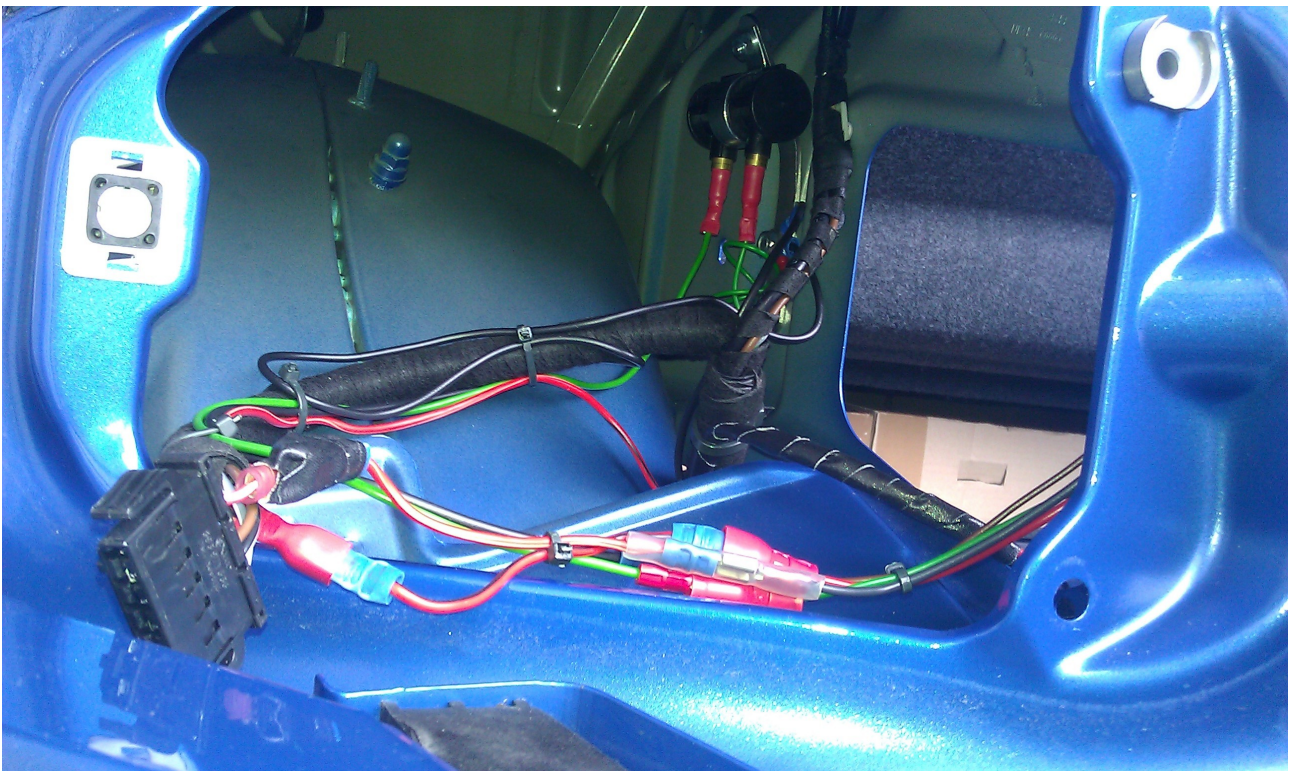
[Bild 20: Verkabelung des Multitimer (das ummantelte Kabel von der Bildmitte nach rechts unten gehört nicht zum Standard, das ist mein Batterieladekabel...)]
