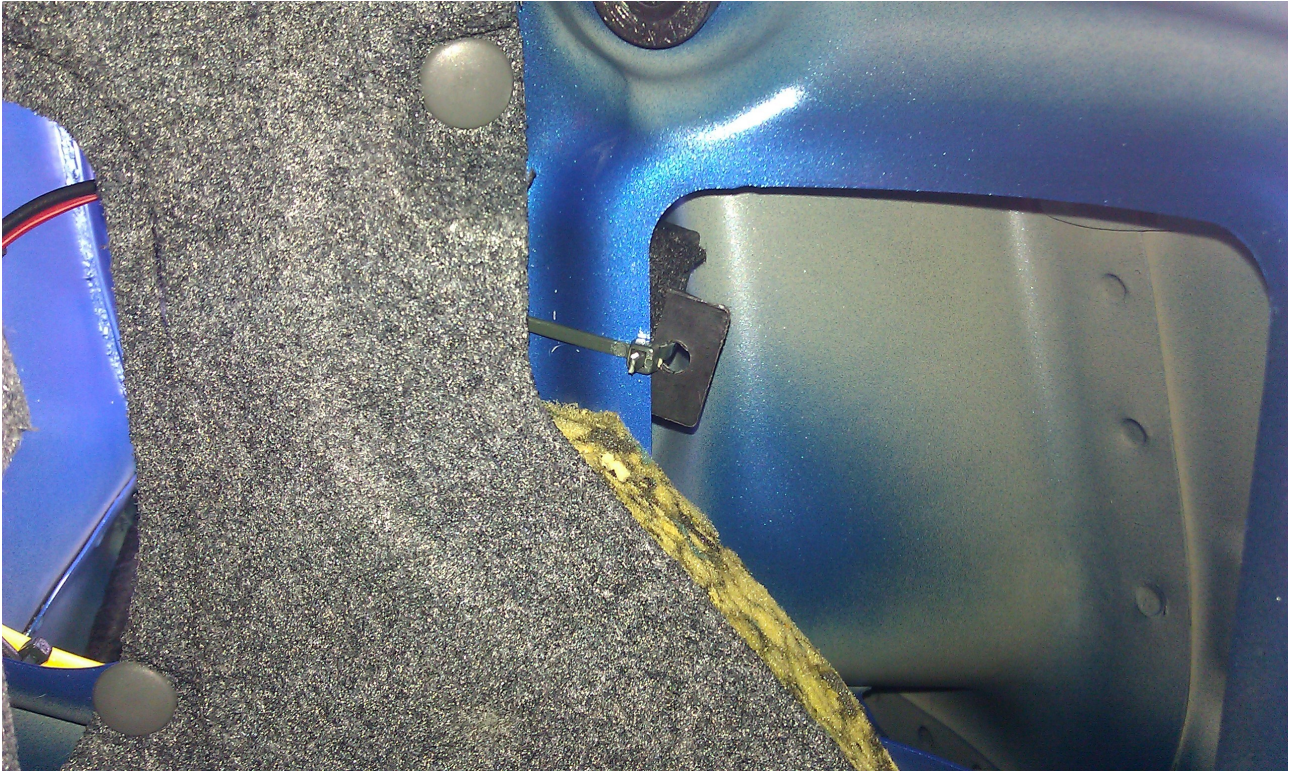
[Bild 18: Relaisbefestigung vom Kofferraum aus gesehen]
