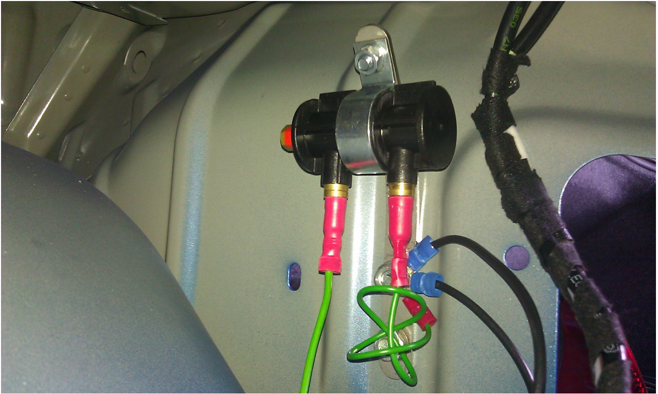
[Bild 19: Fliehkraftschalter mit montierten Massekabeln (und schon verbundenem MT links)]
