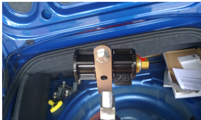
[Bild 09, 10, 11: Fliehkraftschalter mit zurechtgebogenem Befestigungsband]
