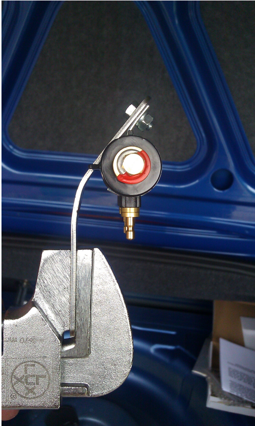
[Bild 09, 10, 11: Fliehkraftschalter mit zurechtgebogenem Befestigungsband]
