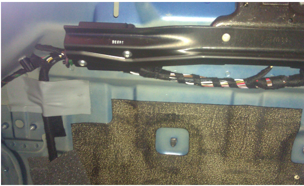
[Bild 05 und 06: Rückwand rechts und links nach Entfernen der Verkleidung]
