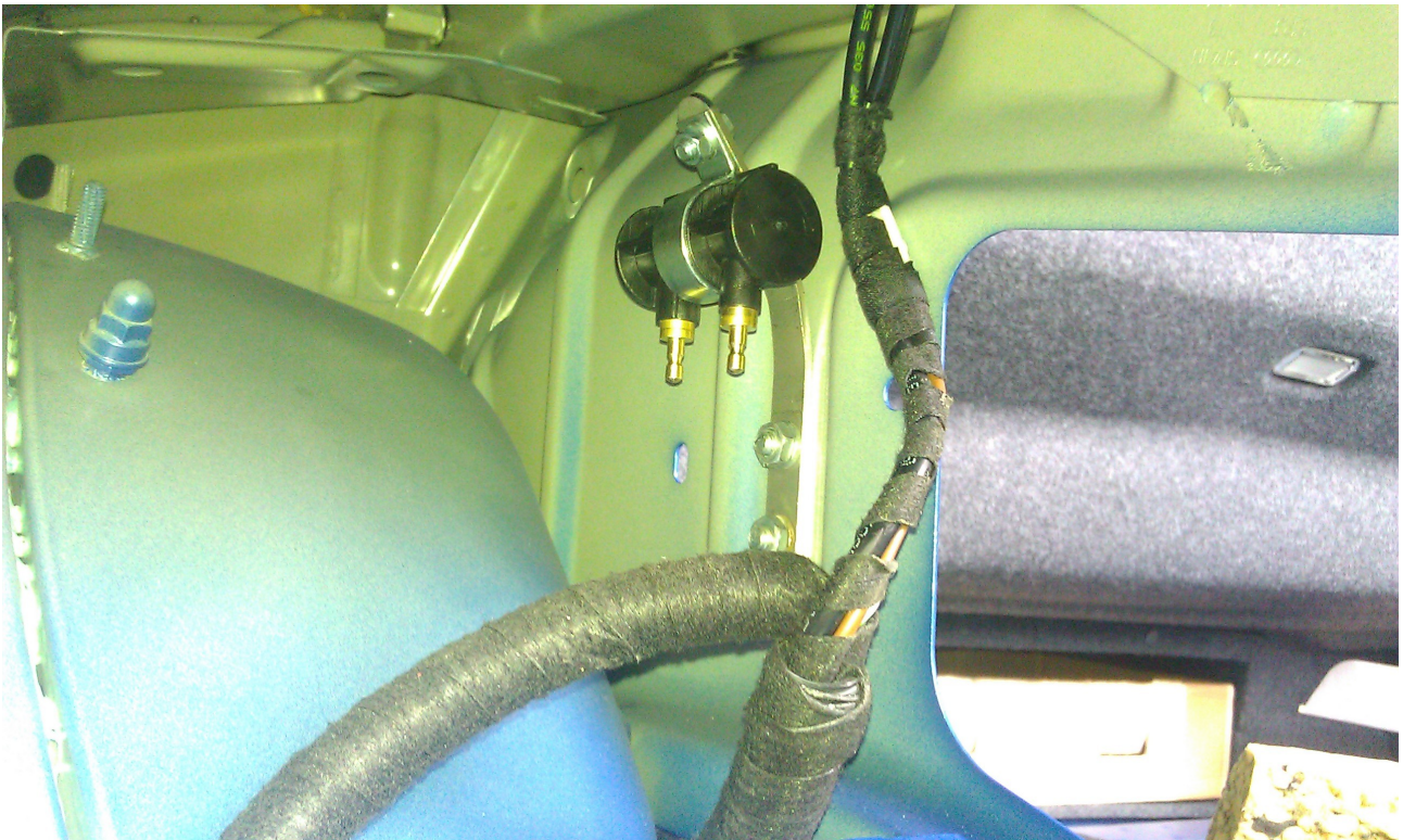
[Bild 12: Montierter Fliehkraftschalter]
