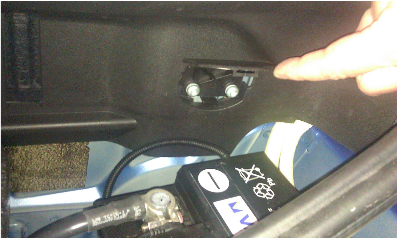
[Bild 04: linke untere Befestigung der Rückwandverkleidung]
